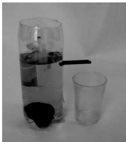
Slika 3 a): Odrezana plastenka s cevko in vodo. 3 b): Kroglica izpodrine vodo, ki izteče v kozarec.
