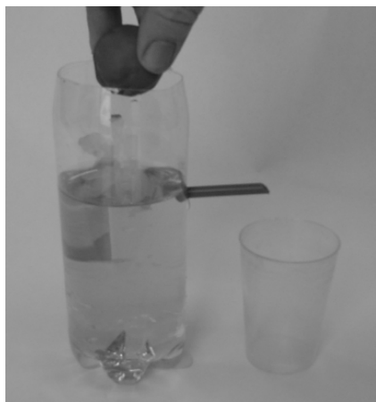
Slika 3 a): Odrezana plastenka s cevko in vodo. 3 b): Kroglica izpodrine vodo, ki izteče v kozarec.
